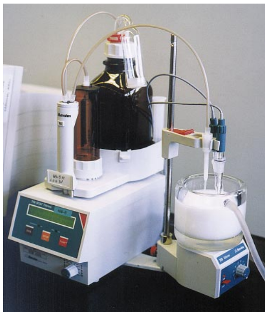
Forsøgsopstillingen i laboratoriet. På billedet ses fra højre reaktionskammer og titratorenhed, der styrer tilsætningen af base. Data opsamlles på en PC, der samtidig styrer titratorenheden.
