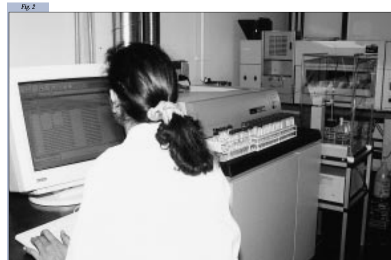
Laborant Suraya Jabin betjener ICP-massespektromeret. Massespektromeret kan kobles direkte til separationssystemer, som adskiller selenforbindelser i blodplasma eller urin.
