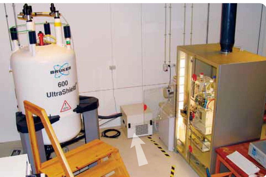
HPLC-NMR apparaturet ved Danmarks Farmaceutiske Universitet. I glasskabet til højre ses HPLC delen, som er forbundet til NMR apparatet til venstre med tynde kapillarer, som ses ved pilen.
