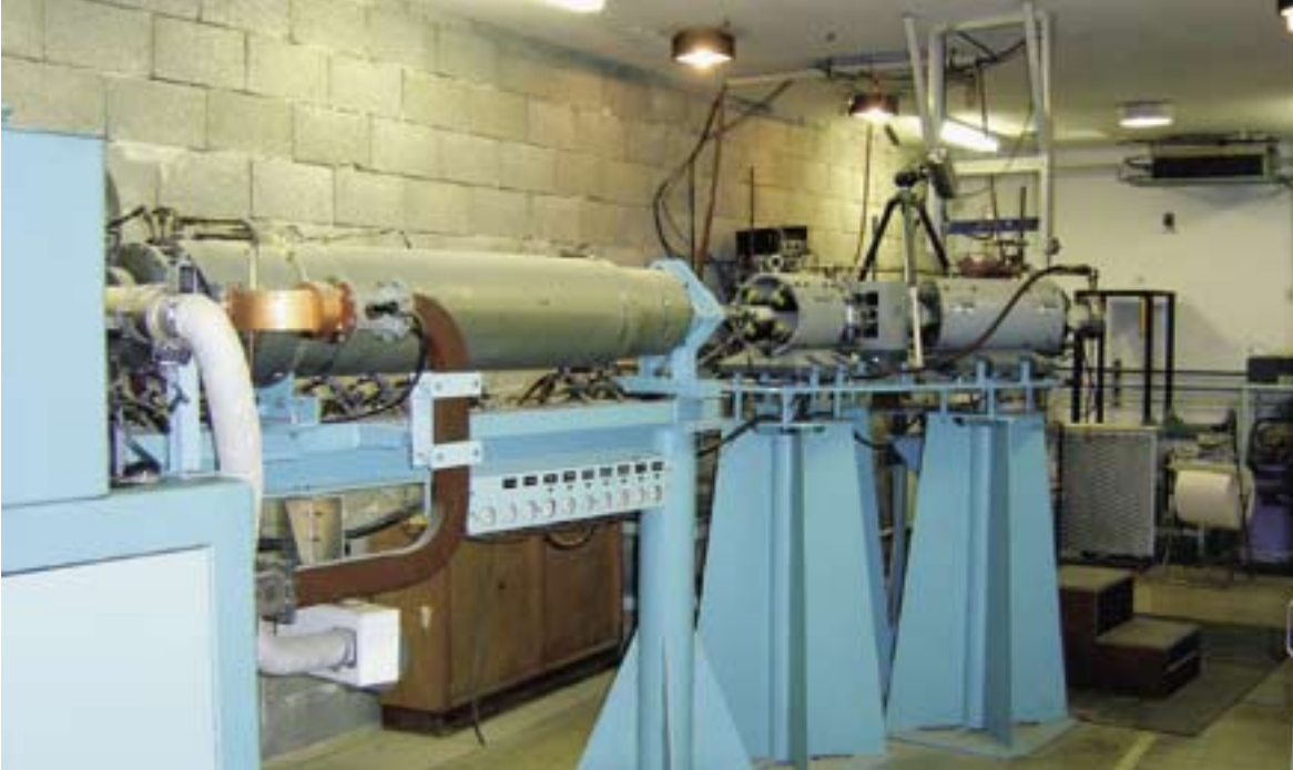
Puls-radiolyseudstyret på universitetet i Jerusalem består af en ca. 6 m lang accelerator, som kan udsende elektronpulse i nanosekund-perioder. Pulsene sendes gennem prøven, som er anbragt i en 1 cm optisk celle (ses ikke på billedet).
