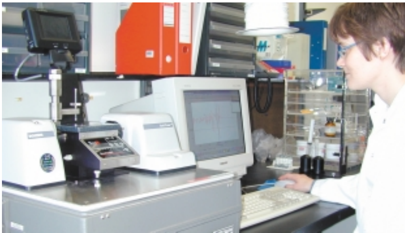
FTIR-spektrofotometeret. I dette projekt anvendes udstyret til undersøgelse af proteiners rumlige struktur. Der findes også mange andre anvendelsesmuligheder, eksempelvis kontrol af råvarekvalitet.
