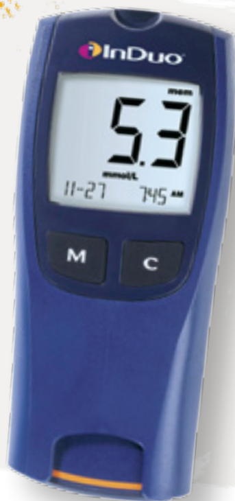
Fig. 8.3: Eksempel på integrationen af medicin og teknologi. InDuo™ (udviklet af Novo Nordisk), der er en kombination af en blodsuktermåler og en insulinodoser med hukommelse. Den husker, hvornår den sidste insulin-dosis blev givet og dosisstørrelse. Ideen bag hukommelsen er, at diabetikeren ikke pludselig sidder på arbejdet eller i skolen og spørger sig selv: ”Tog jeg mon min morgeninsulin???” Inde i InDuo™ findes insulinbeholderen, som doseres og påsættes en nål.
